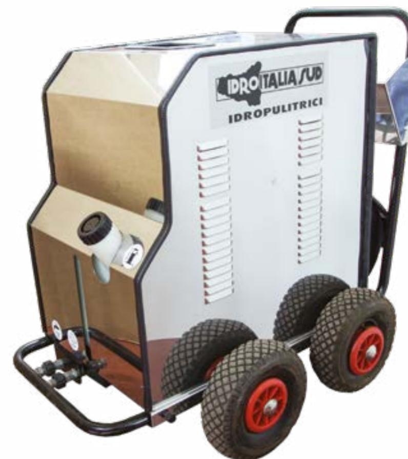
Macchina professionale, composta da una caldaia verticale con serpentina a doppia spirale INOX, controllata da una fotocellula che ne assicura il corretto funzionamento. Il bruciatore ha un motore di 220 volt indipendente dal motore principale. Questa macchina ha lo scopo di riscaldare l'acqua fino a 150°C. Copertura interamente in acciaio INOXn 430. Il serbatoio del gasolio ha un capacità' di 25 litri.
