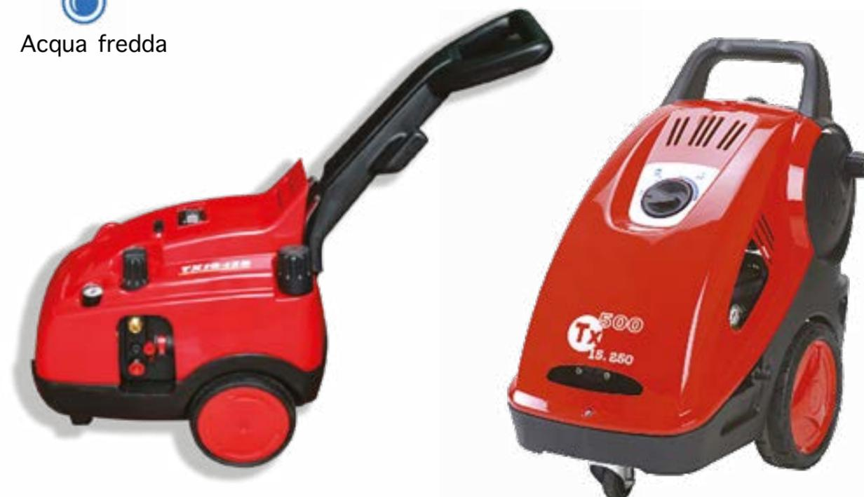
Idropultrice professionale ad acqua fredda con gruppo pompa motore a 1450 giri/minuto, motore a doppio cuscinetto e pompa a tre pistoni in ceramica, con bielle e albero a camme.
