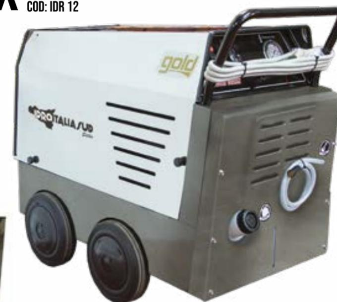
Idropulitrice serie professionale con pompa a tre pistoni in ceramica. Motore elettrico con due cuscinetti, caldaia verticale con serpentina a doppia spirale INOX; Il bruciatore ha un motore da 220 volt indipendente dal motore principale.
