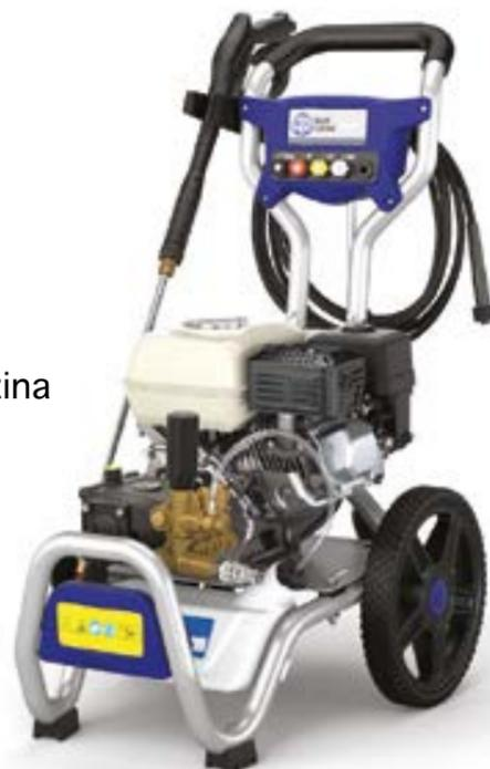
Carrello completo di manico con due ruote e piedini antivibranti. Pompa a pistoni con sistema biella-manovella. Valvola di by-pass automatica. Valvola termica. Aspirazione detergente incorporata. Motorizzato Honda, con sensore mancanza olio. Livelli olio ispezionabile. Tappi ed asole di scarico per agevolare la manutenzione ed il cambio olio. Filtro acqua ispezionabile.
