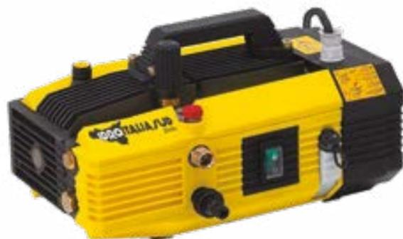
Pompa a 3 pistoni in ceramica, con sistema biella-manovella Valvola di by-pass automatica. Regolazione della pressione. Indicatore della pressione. Aspirazione detergente incorporata. Motore elettrico con protezione termica. Lunghezza cavo elettrico 5m. Filtro acqua. Tubo alta pressione, pistola e lancia. Testina selezione alta e bassa pressione, getto concentrato o a ventaglio
