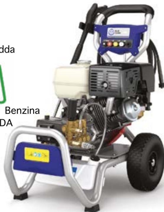
Idropulitrice avente carrello completo di manico con due ruote pneumatiche gonfiabili e piedini antivibranti. Pompa a pistoni con sistema biella-manovella. Valvola di by-pass automatica. Regolazione della pressione. Valvola termica. Aspirazione detergente incorporata. Motorizzato Honda, con sensore mancanza olio. Livelli olio ispezionabili. Tappi ed asole di scarico per agevolare la manutenzione ed il cambio olio. Filtro acqua ispezionabile.
