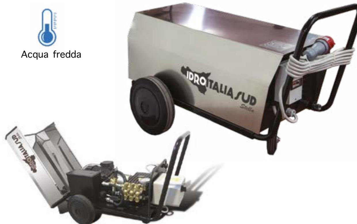
Idropultrice professionale ad acqua fredda con gruppo pompa motore a 1450 giri/minuto, motore a doppio cuscinetto e pompa a tre pistoni in ceramica, con bielle e albero a camme.
