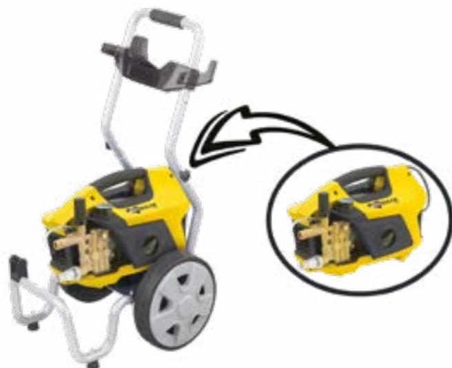
Pompa a 3 pistoni in ceramica, con sistema biella-manovella. Valvola di sicurezza automatica con azzeramento della pressione nella testa pompa. Testa pompa in ottone. Protezione termica del motore. Regolazione della pressione. Manometro. Aspirazione detergente. Filtro acqua ispezionabile. Lunghezza cavo elettrico 5 m.
