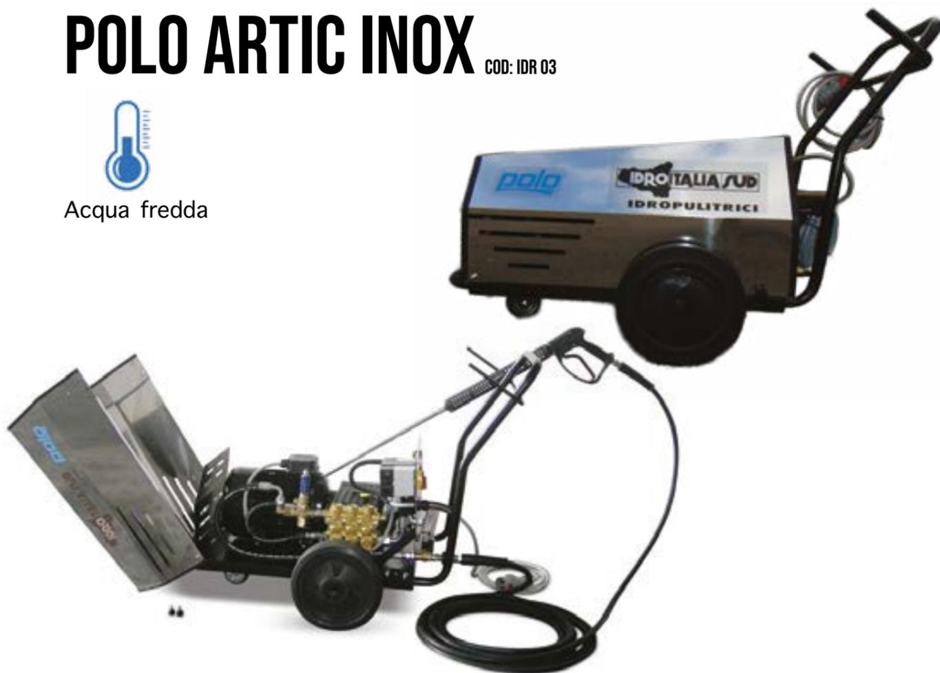
Idropultrice professionale ad acqua fredda con gruppo pompa motore a 1450 giri/minuto, motore a doppio cuscinetto e pompa a tre pistoni in ceramica, con bielle e albero a camme.
