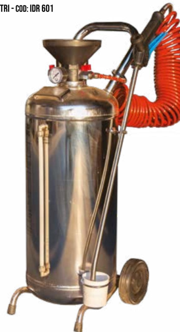
Nebulizzatore NBZ IDROITALIASUD in acciaio inox a funzionamento pneumatico. Il serbatoio, che dispone di indicatore di livello, viene riempito del liquido per circa 3/4 della sua capacità e caricato d'aria compressa a massimo 8 bar: non necessita quindi di un collegamento continuo alla rete d'aria compressa. Il nebulizzatore NBZ è dotato di tubo spiralato, lancia in acciaio inox con ugello spray e protezione ugello.
