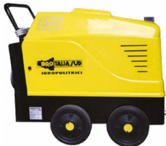
Idropulitrice serie professionale con pompa a tre pistoni in ceramica. Motore elettrico con due cuscinetti, caldaia verticale con serpentina a doppia spirale INOX; Il bruciatore ha un motore da 220 volt indipendente dal motore principale.
