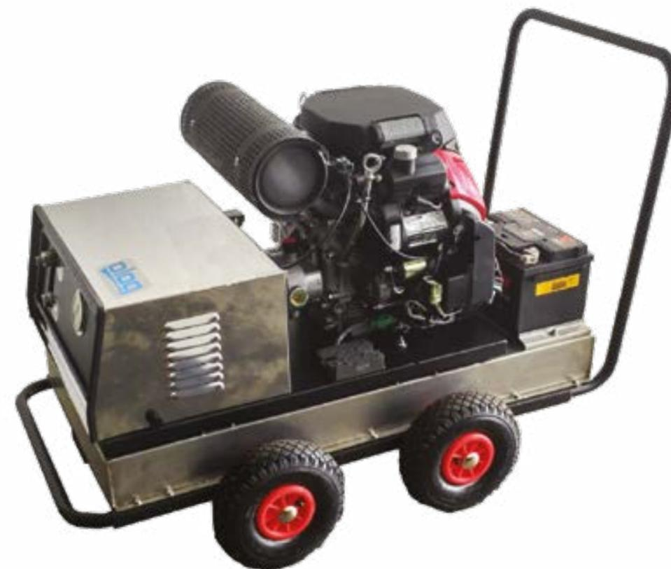
Idropulitrice professionale autonoma, ad acqua fredda, con alimentazione a motore DIESEL (LOMBARDINI 25 HP), con avviamento elettrico, collegato alla pompa tramite riduttore di giri, con rapporto 1:2. La pompa e' composta da tre pistoni in ceramica con bielle ed albero a camme.
