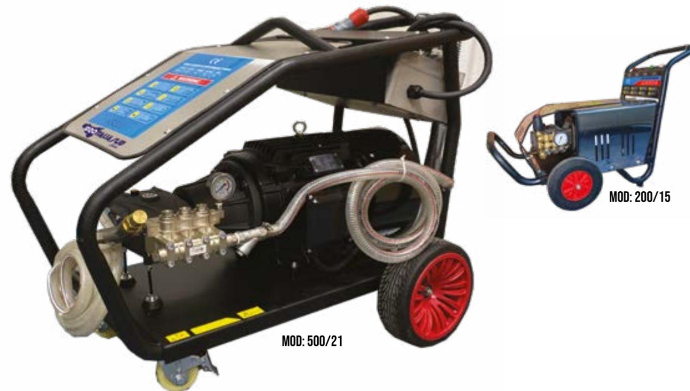
Idropulitrice professionale ad acqua fredda con gruppo pompa motore a 1450 giri/minuto, motore a doppio cuscinetto e pompa a tre pistoni in ceramica, con bielle ed albero a camme.
