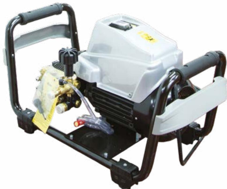
Idropultrice professionale ad acqua fredda con gruppo pompa motore a 1450 giri/minuto, motore a doppio cuscinetto e pompa a tre pistoni in ceramica, con bielle e albero a camme.
