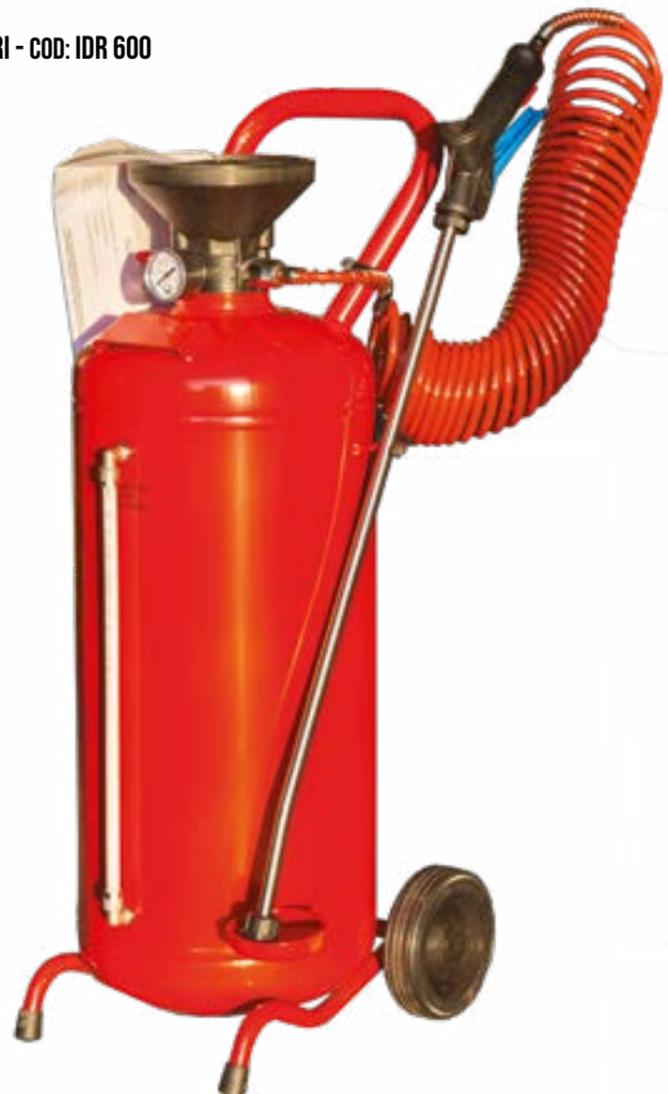
Nebulizzatore NBZ IDROITALIASUD in ferro a funzionamento pneumatico. Il serbatoio, che dispone di indicatore di livello, viene riempito del liquido per circa 3/4 della sua capacità e caricato d'aria compressa a massimo 8 bar: non necessita quindi di un collegamento continuo alla rete d'aria compressa. Il nebulizzatore NBZ è dotato di tubo spiralato, lancia in acciaio inox con ugello spray e protezione ugello.
