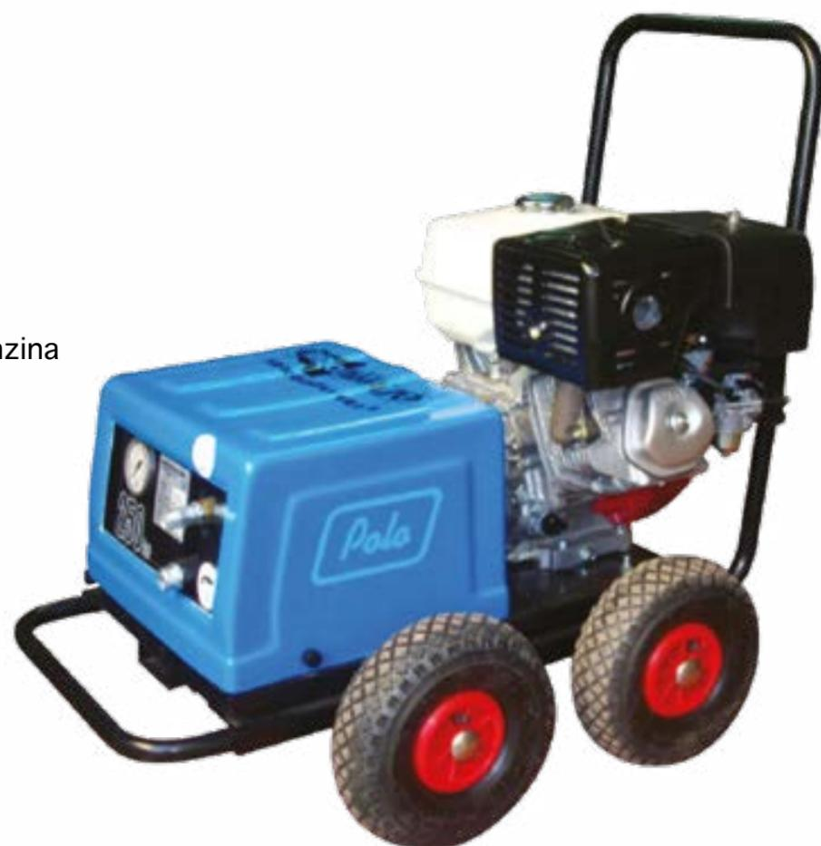
Idropulitrice professionale ad acqua fredda con motore a benzina con avviamento a strappo, acceleratore automatico con il quale alla richiesta di potenza, tramite impugnatura, si ottiene l'accelerazione del motore. La pompa e' composta da tre pistoni in ceramica con bielle ed albero a camme.
