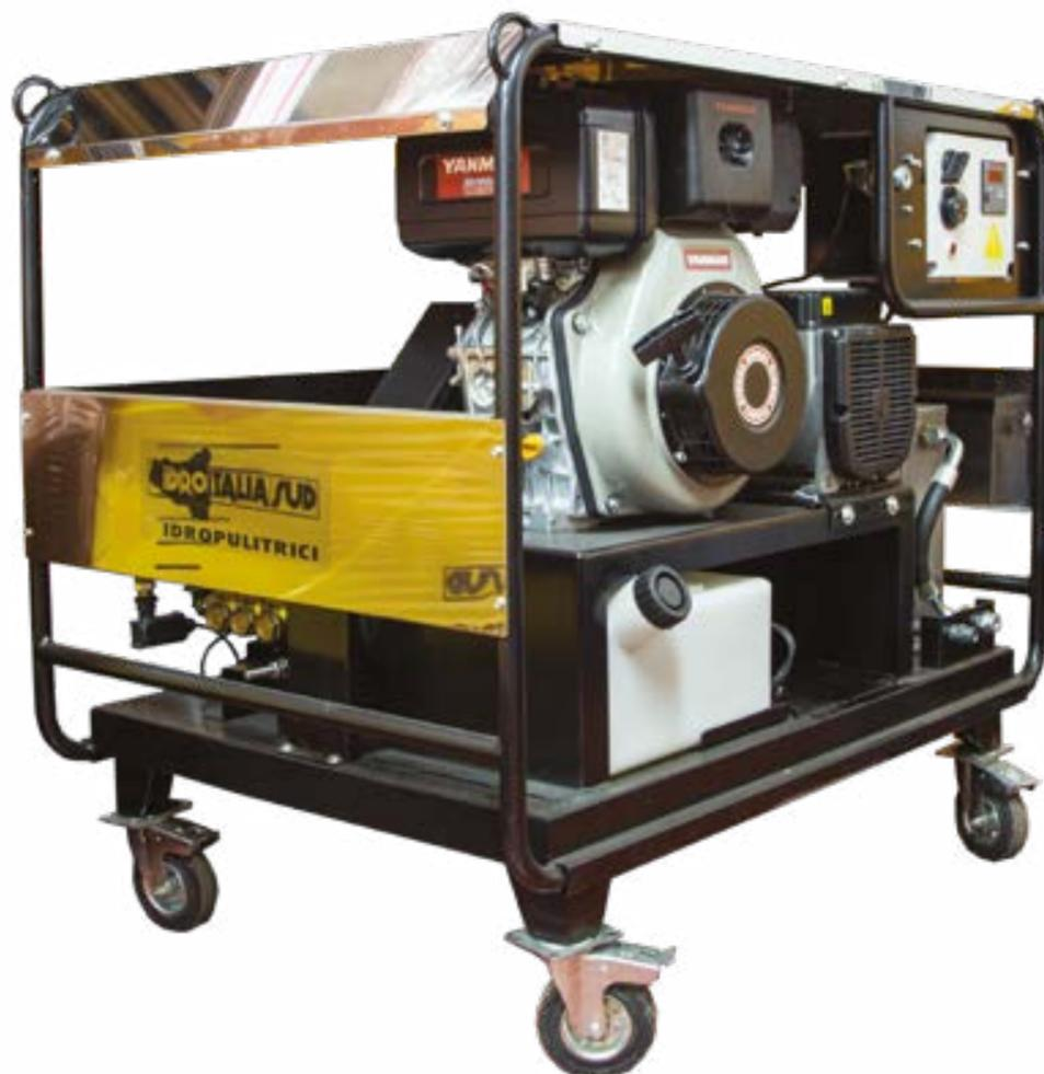
Idropultrice professionale ad acqua fredda con motore a diesel con avviamento automatico, acceleratore automatico con il quale alla richiesta di potenza, tramite impugnatura, si ottiene l'accelerazione del motore. La pompa e' composta da tre pistoni in ceramica con bielle ed albero a camme.
